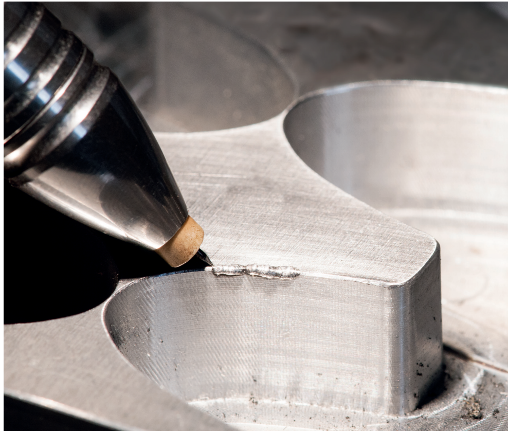
Präziser Auftrag: Reparatur einer Aluminiumform. © Botzian & Kirch
